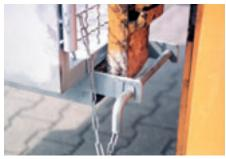
3 Bolzen zur Sicherung gegen Verschieben in Gabellängsrichtung
